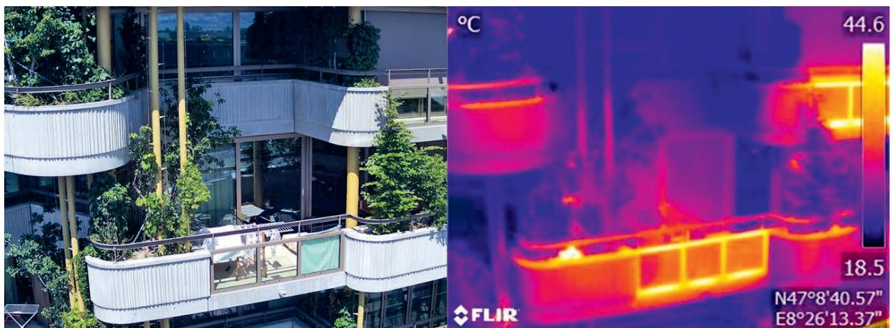
Links: Aufnahme im sichtbaren Bereich. Rechts: Die Infrarotthermografie des gleichen Abschnitts gibt Informationen über die Verteilung der Oberflächentemperaturen.
